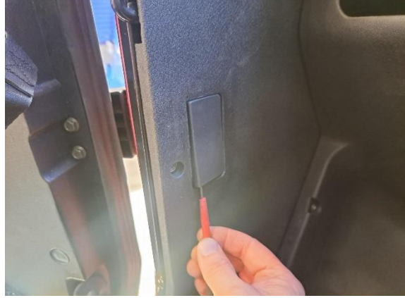
Raota alemman oven saranan kiinnitysmuttereiden suojakantta (pieni talttameisseli).
