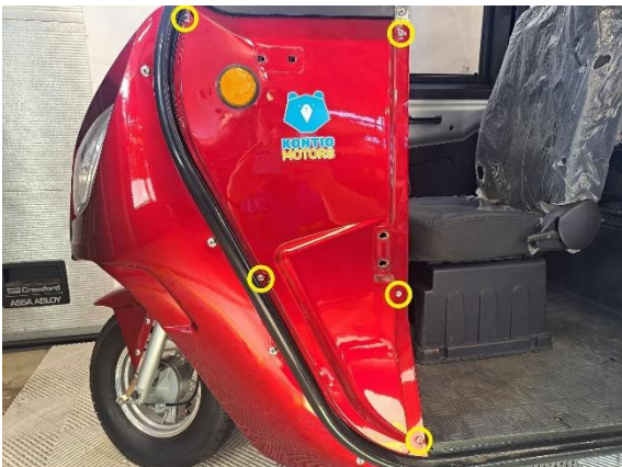
Irrota etusivupaneelin kiinnitysruuvit (ristipäämeisseli ph2).
