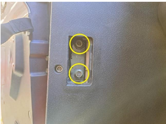
Irrota oven saranoiden kiinnitysmutterit (hylsy 12 mm).
