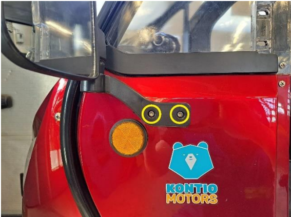
Irrota peilin kiinnityspultit (kuusiokoloavain 5 mm). Ota peili pois.
