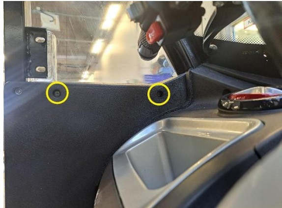
Irrota etummaisen sivuikkunan kiinnitysruuvit (ristipäämeisseli).
