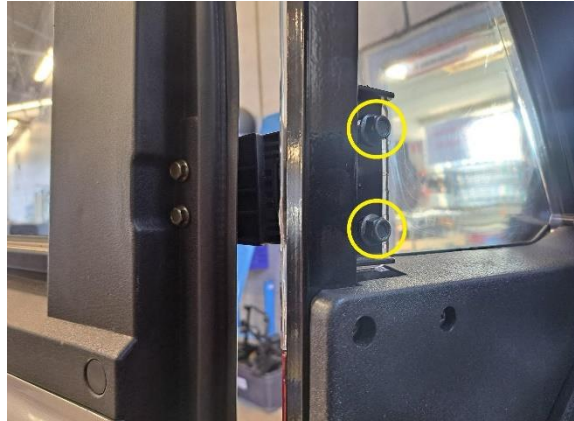
Irrota oven saranoiden kiinnitysmutterit (hylsy 12 mm).
