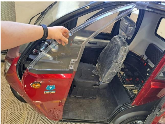
Ota sivuikkuna ja sivupaneeli pois.
